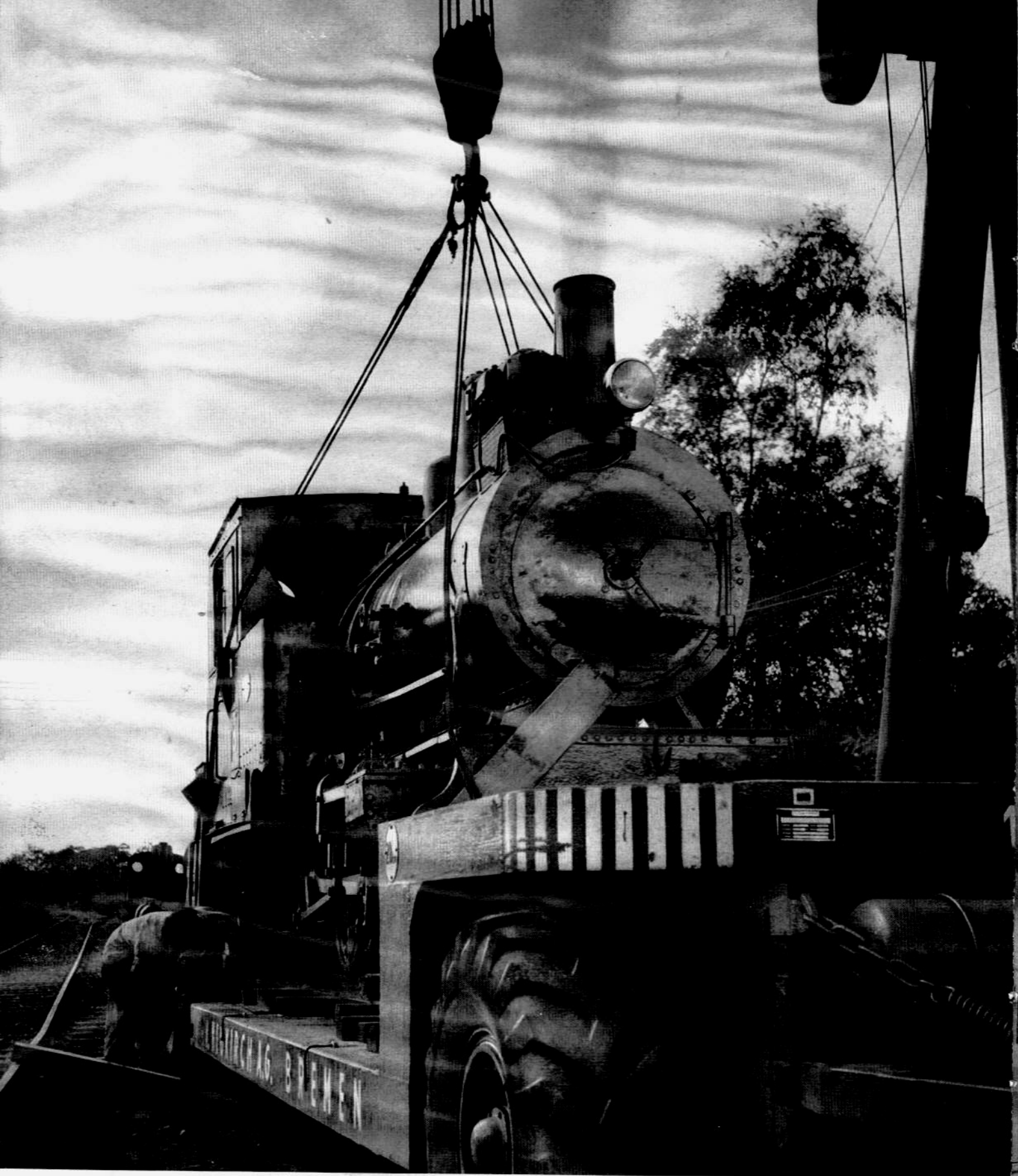
Auf einen unserer luftbereiften Schwerlasttieflader wird eine unter Dampf stehende Lokomotive ohne zeitraubende Arbeitsunterbrechung an einen neuen Einsatzort befördert
